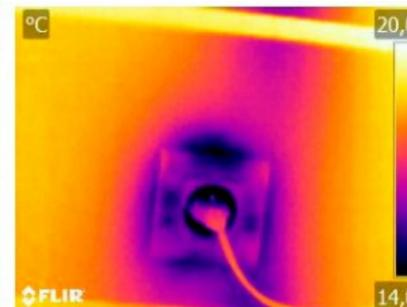
◀ Thermographie de façade montrant un défaut d'isolation après travaux sur le haut du toit (zone jaune)
